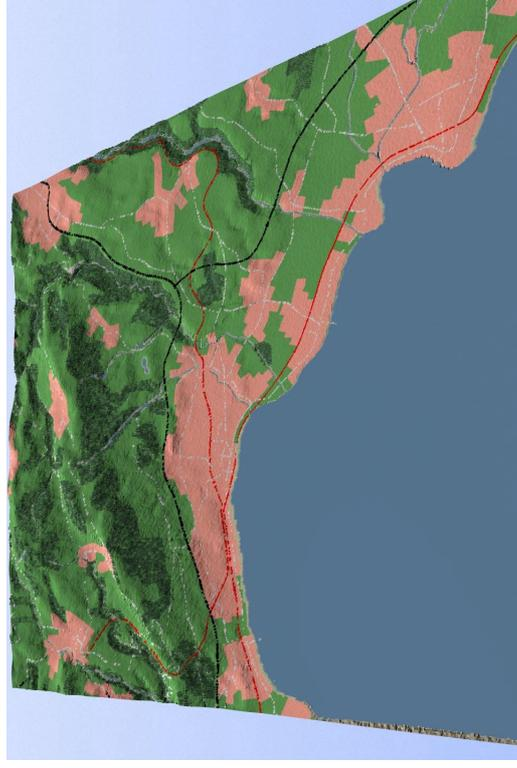
*In 4 Schritten vom DHM zu einer möglichen 3D-Darstellung der Vektordaten: 1) nur DHM 2) See hinzugefügt 3) alle Primärflächen mit Effekten versehen 4) zusätzlich noch die linearen Vektordaten bearbeitet*
