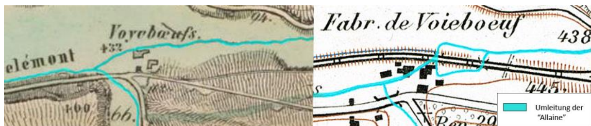
Abbildung 9 Umleitung der Allaine im Bereich der Fabrik Voyeboeuf (Vergleich: Carte des environs de Porrentruy 1852 links und Siegfriedkarte 1878 rechts)
