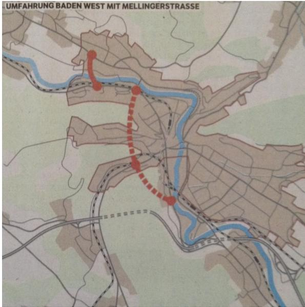
Abb. 4.11: Variante A. Der Verkehr wird durch einen Tunnel von der Siggenthaler Brücke bis zur Neuenhoferstrasse geführt.
