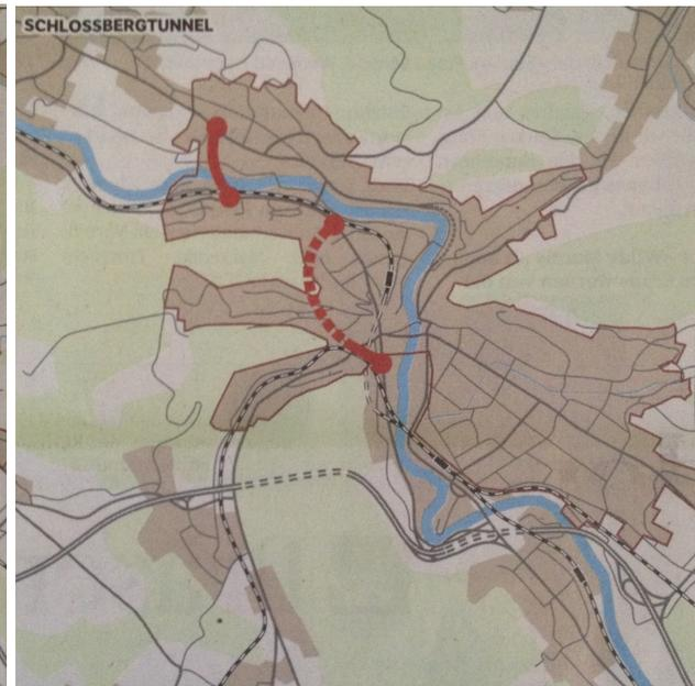
Abb. 4.14: Variante D: Ähnlich wie die Variante A sieht dieser Vorschlag ebenfalls einen Tunnel von der Siggenthaler Brücke aus vor, allerdings nur bis etwa zur Kreuzung Schulhausplatz.
