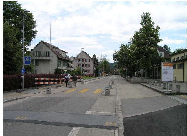
*Abbildung 8.3: Künstliche Verengung an der Brünenstrasse zur Regulierung des Durchgangsverkehrs.*
