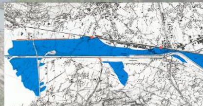
Überflutungsgebiet bei einem Extremereignis
