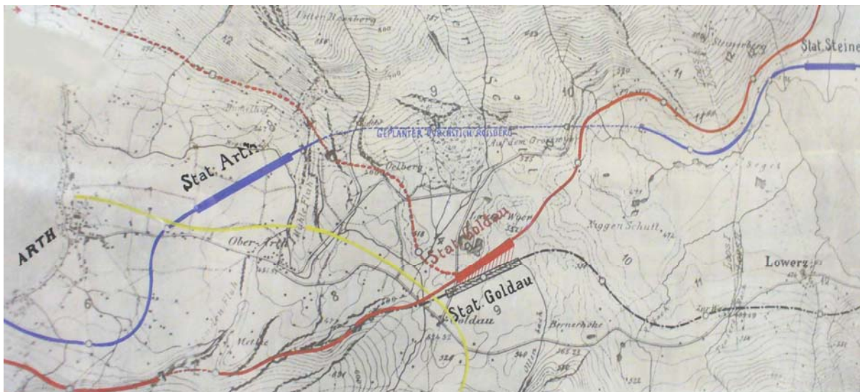
Abb. 13: Blaue Linie: Einst geplantes Projekt der Gotthardbahn mit Station in Arth; Rote Linie: Heutige Bahnanlage; Gelbe Linie: Arth-Rigi-Bahn mit Station in Arth vor 1959; Schwarze Linie: Variante Lauerz mit Durchstich Urmiberg.
