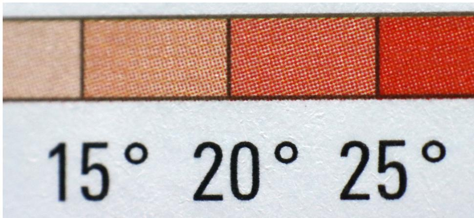
**Abbildung 2.13:** Gitteranordnung der Farben beim Mehrfarbendruck. Mit einem Makro-Objektiv können die einzelnen Punkte des Gitters beim Druck sichtbar gemacht werden. In dieser Farbskala aus dem SWA ist die unterschiedliche Punktgröße bei verschiedener Helligkeit klar sichtbar. (Bild fotografiert aus dem SWA (EDK, 2017))
