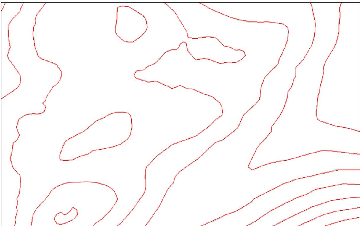
Grau: ungeneralisiert, rot: generalisiert mit Toleranzwert: 25 cm
