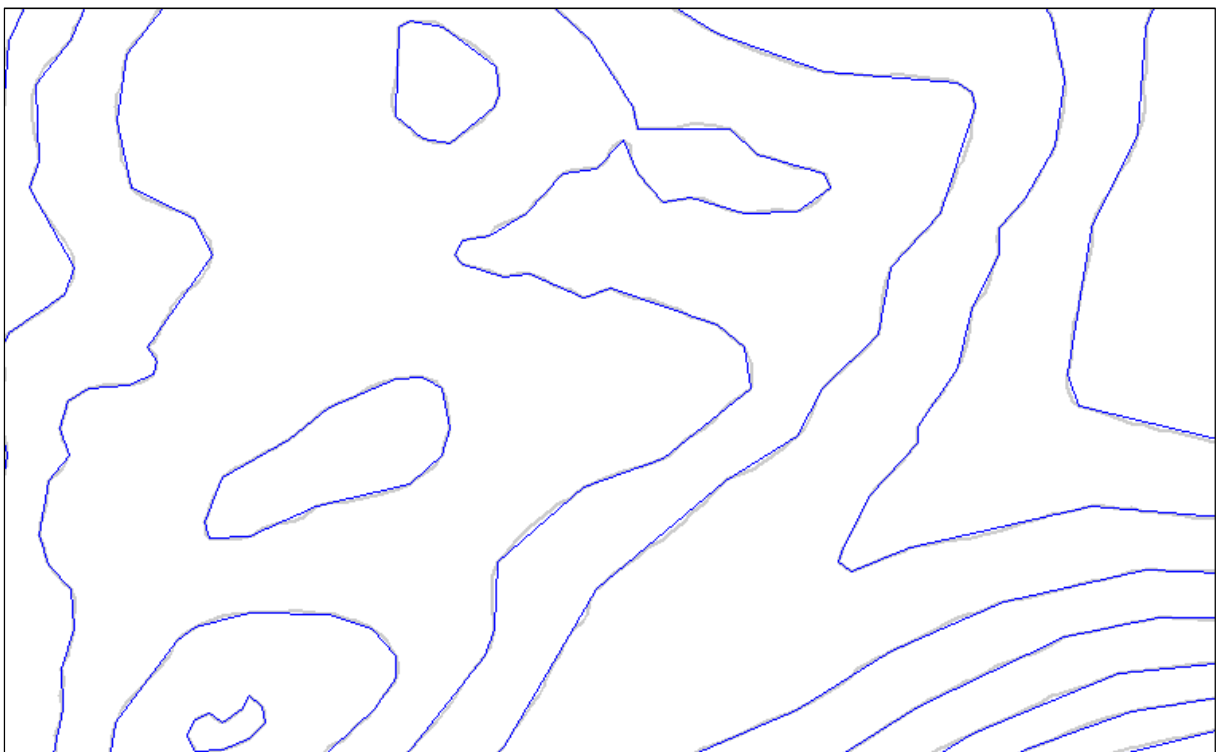
Grau: ungeneralisiert, blau: generalisiert mit Toleranzwert: 75 cm
