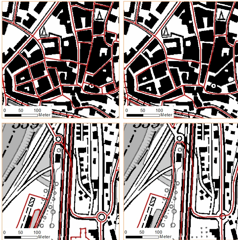
Abbildung 3.15: Beispiele für eine manuell durchgeführte Bereinigung der Polygonflächen. Links: Rohzustand. Rechts: Bearbeitetes Resultat.
