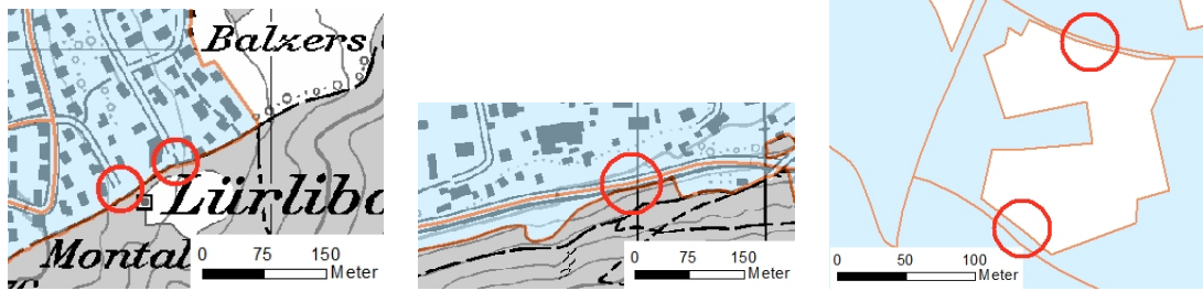
Abbildung 3.14: Unerwünschte Ergebnisse nach Unterteilung der Siedlungsfläche. Links: Fehlende Unterteilung bei Sackgassen. Mitte und rechts: Grosse Polygone mit schmalen Streifen.
