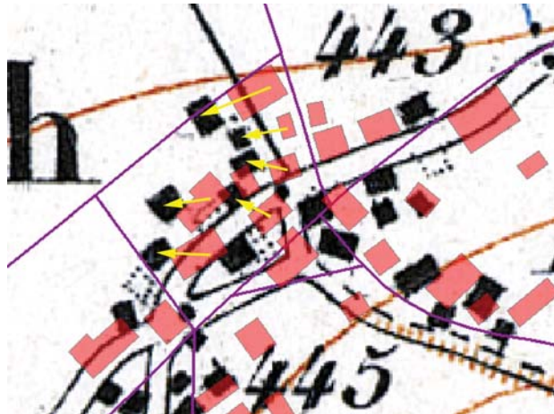
Abbildung 3.3.: Versatz zwischen Vektordaten (Stand 1956/57) und Raster Karte (Siegfried 1872/76) in Ipsach gelbe Pfeile: Vermutlicher Versatz einzelner Häuser
