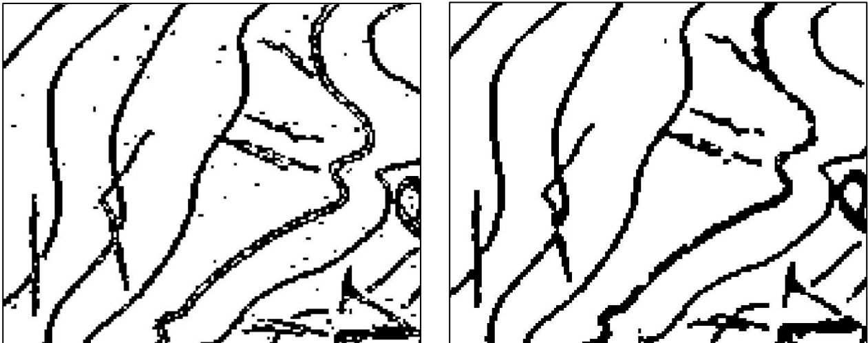
Abbildung 12: Blaue Höhenlinien links ohne Filter, rechts mit Filter
