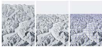
Abb.2 von links nach rechts: Zentralperspektive; progressive Perspektive; progressive Perspektive mit Konstruktionsgitter
