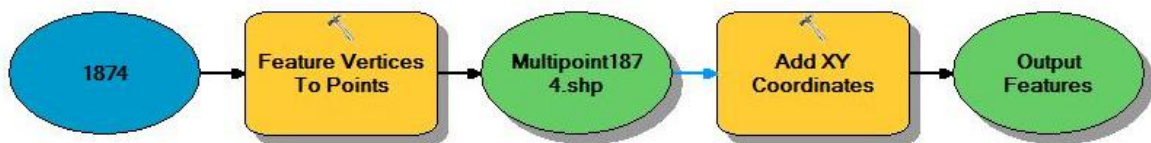
Abbildung 10: Erklärung der benutzten Methode, um Koordinaten der Polyline darzustellen.
