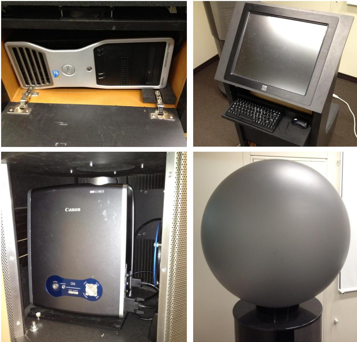
Abb. 2: Elemente eines taktilen Hyperglobus: Rechner, Bildschirm, Beamer, Projektionsfläche
