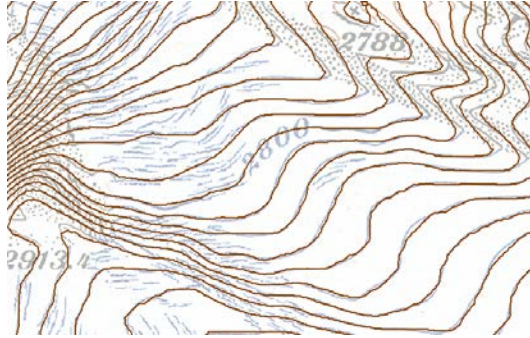
Abbildung 3.11.: Aus dem generierten DHM mit 25 Meter Zellgrösse abgeleitete Höhenlinien (braun) im Vergleich mit der Grundlagenskarte.
