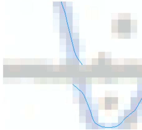
Abbildung 3.7.: Unterbrechung und Ablenkungen an den Enden der vektorisierten Höhenlinien wegen einer kreuzenden, anders farbigen Linie.
