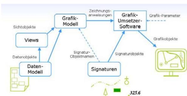
Die Datenobjekte aus dem Datenmodell sollen auf dem Bildschirm mit Signaturen dargestellt werden. Die Zeichnungsregeln im Grafikmodell verbinden die Datenobjekte mit den jeweiligen Signaturen. Diese müssen vorgängig mit bestimmter Struktur erstellt werden. Das Standard-Signaturenmodell gibt diese Struktur und die grafischen Möglichkeiten vor.
