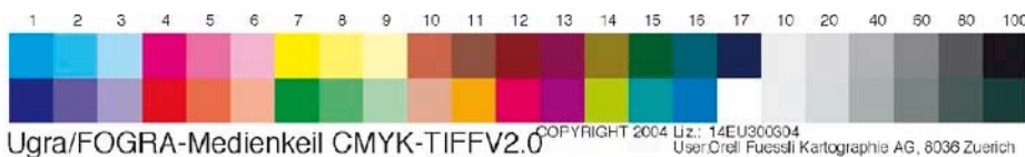
Abb. 10 Ugra/Fogra Medienkeil CMYK mit 46 Referenzfelder.
