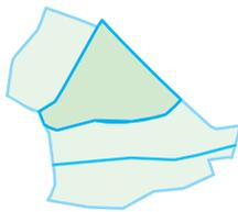
Mehrfach übereinander gelagerte Flächen sind leicht mit der Transparenz- Funktion erkennbar. Einfach die mehrfach überdeckte Fläche zu entfernen, würde das Problem nicht lösen. Meistens sind einige Knoten und/oder einige Grenz- Path nicht korrekt.
